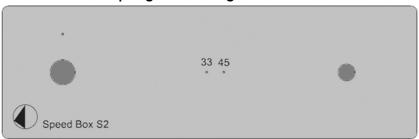
Der Antriebsriemen muss sich auf der Riemenscheibe des Motor-Pulleys mit dem kleinen Durchmesser befinden. Drücken der Taste **33 45** schaltet zwischen den Geschwindigkeiten 33 und 45 U/min um. Die gewählte Geschwindigkeit wird durch eine blaue Leuchtdiode angezeigt.
