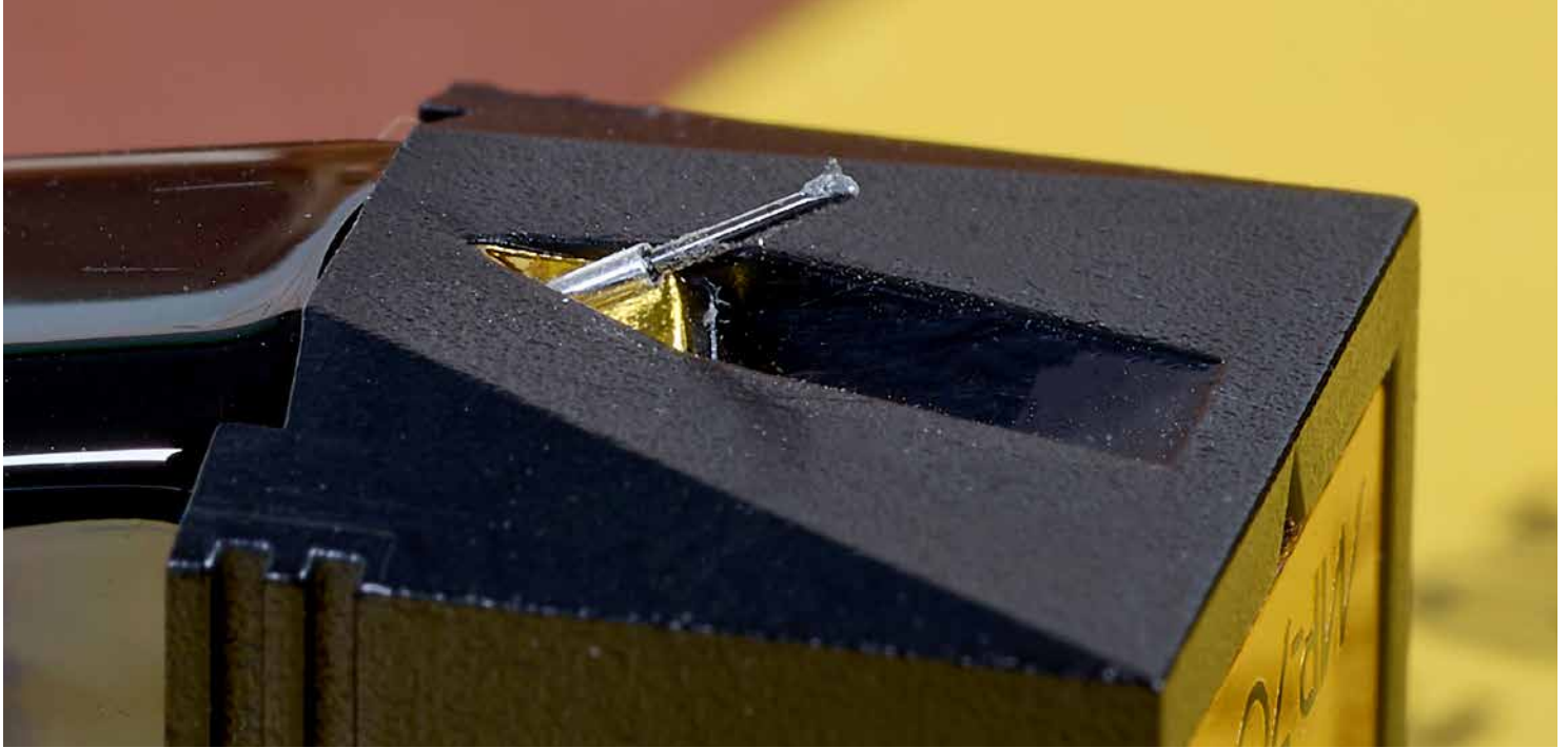
Der Abtastdiamant mit extrem scharfem Micro-Ridge-Schliff ist durch einen winzigen Tropfen Kleber mit dem leichten und dennoch sehr steifen Bor-Nadelträger verbunden. Die Geometrie ist genauestens eingehalten, wie man es von Nagaoka gewöhnt ist.
