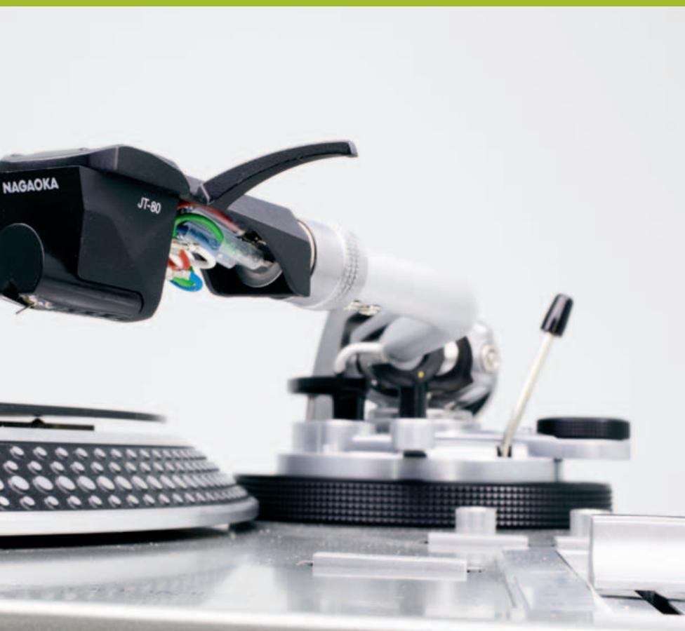
ter Magnet dazu), was einen Generator ergibt, der elektrische Ströme an die Anschlusspins schickt. Die Ausgangsspannung beider Systeme ist auf ähnlichem Niveau, beide Systeme gehören an einen MM-Phono-Eingang, wie man ihn heute wieder an vielen Verstärkern und sogar Aktivlautsprechern findet. Außerdem haben beide Systeme gemeinsam, dass man den vorderen Teil des Gehäuses abnehmen kann. Dieser beherbergt den Nadelträger mit Diamant.
