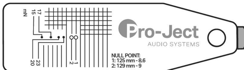
Um die für den zu montierenden Tonabnehmer empfohlene Auflagekraft einzustellen, senken Sie die Nadelspitze auf einen der beschrifteten Messpunkte (15, 17, 20 und 23mN) oder einem gedachten Punkt zwischen den Messpunkten ab, welcher der empfohlene Auflagekraft entspricht. Steht die Waage danach waagrecht, ist die Auflagekraft korrekt.
