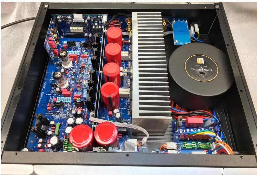
Mit derselben Sorgfalt wurde auch die Kleinsignalsektion behandelt, angefangen bei den vergoldeten Cinchbuchsen bis hin zu den ebenfalls vergoldeten stabilen Lautsprecheranschlüssen, die nach den aktuellen Vorschriften isoliert sind. Überall im Signalweg werden nur Bauteile höchster Qualität eingesetzt: hoch präzise gekapselte Signalrelais, sorgfältig ausgesuchte Kondensatoren von Mundorf, eng tolerierte Metallfilmwiderstände, keramische Röhrenfassungen mit vergoldeten Kontakten und vieles mehr.
