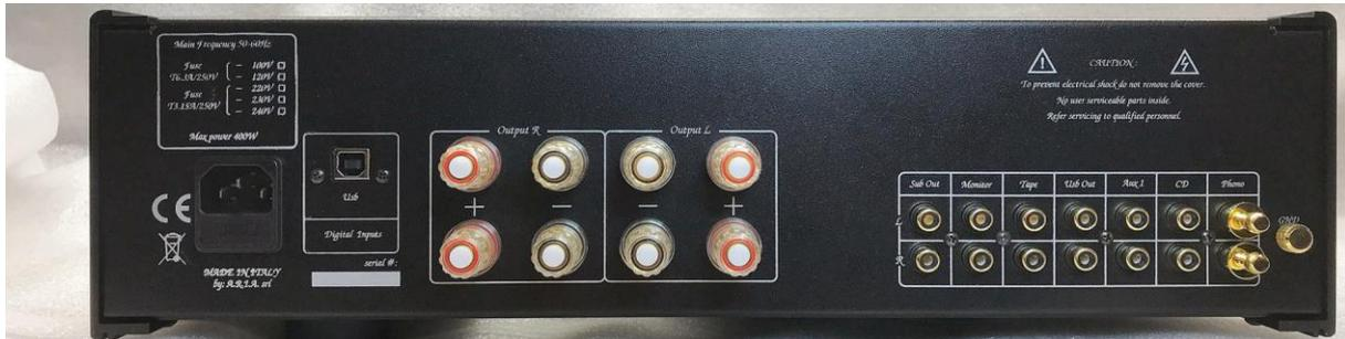
Insgesamt stehen also mit dem USB Anschluß vier Signaleingänge zur Verfügung. Zur Umschaltung dienen hochwertige Miniatur-Relais während die Lautstärkeregelung mit einem Präzisions-Widerstandsnetzwerk und digital gesteuerten Analogschaltern vorgenommen wird. Hiermit ergibt sich wie in Referenzvorstufen ein Regelumfang von 120 dB in präzisen 0,5 dB Schritten.
