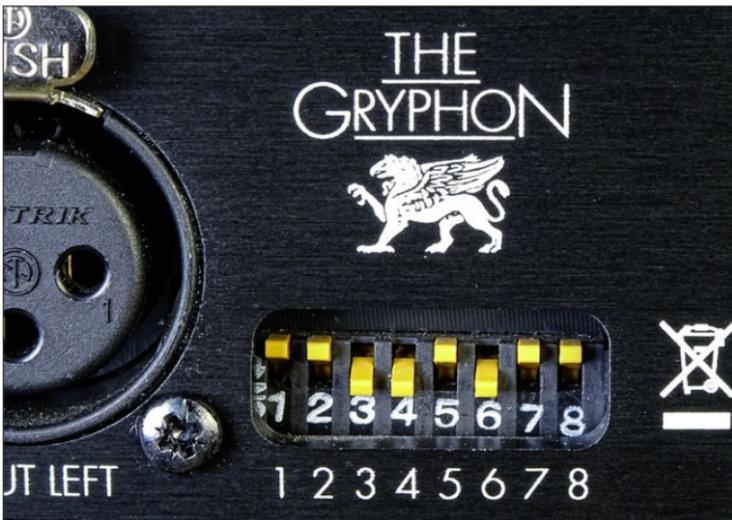
Mittels DIP-Schalterbänke lässt sich die Eingangsimpedanz für MC-Abtaster zwischen 20 und 1.600 Ohm in 15 Stufen einstellen.
