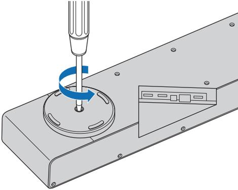
Die Schrauben und Unterlegscheiben werden zur Befestigung der Montagehalterungen und der Soundbar verwendet.
