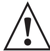
El signo de exclamación dentro de un triángulo equilátero alerta al usuario de la existencia de importantes instrucciones sobre funcionamiento y mantenimiento [asistencial] en la documentación que acompaña al equipo.
