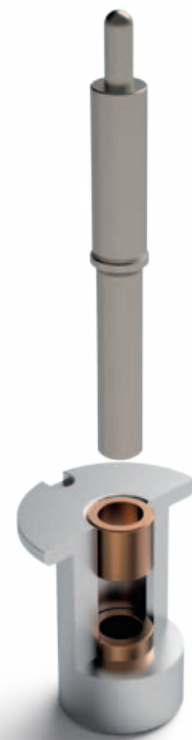
Die Achse aus vakuumgehärtetem Edelstahl ist mit einer Plasmabeschichtung versehen und ruht auf einer Kugel aus Wolframkarbid.
