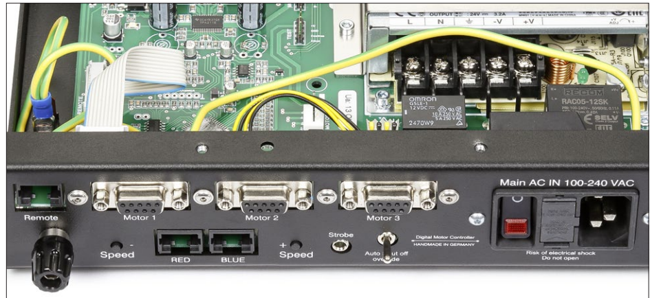
Von den zahlreichen Schnittstellen des externen Versorgungsgeräts DMC-20 benötigt man für den Typhoon Neo nur die mit „Blue“ beschriftete. Das runde Steuerteil wird oben links angeschlossen.
