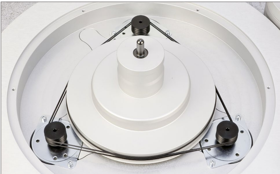
Gleich drei AC-Motoren treiben den soliden Subteller über ebenso viele Kurzriemen an. Diese verbinden die Motoren auch untereinander, damit sich etwaige Unregelmäßigkeiten zwischen ihnen ausgleichen.
