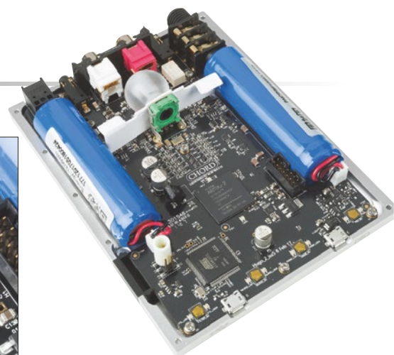
Der aufwendig eingestellte FPGA-Chip und die eigens geschriebene Software sind das Herzstück des Hugo 2 . Die beiden Akkus reichen für etwa acht Stunden Musikwiedergabe aus
