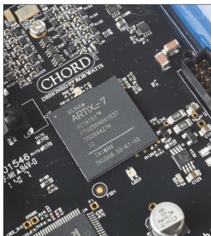
Der aufwendig eingestellte FPGA-Chip und die eigens geschriebene Software sind das Herzstück des Hugo 2 . Die beiden Akkus reichen für etwa acht Stunden Musikwiedergabe aus
