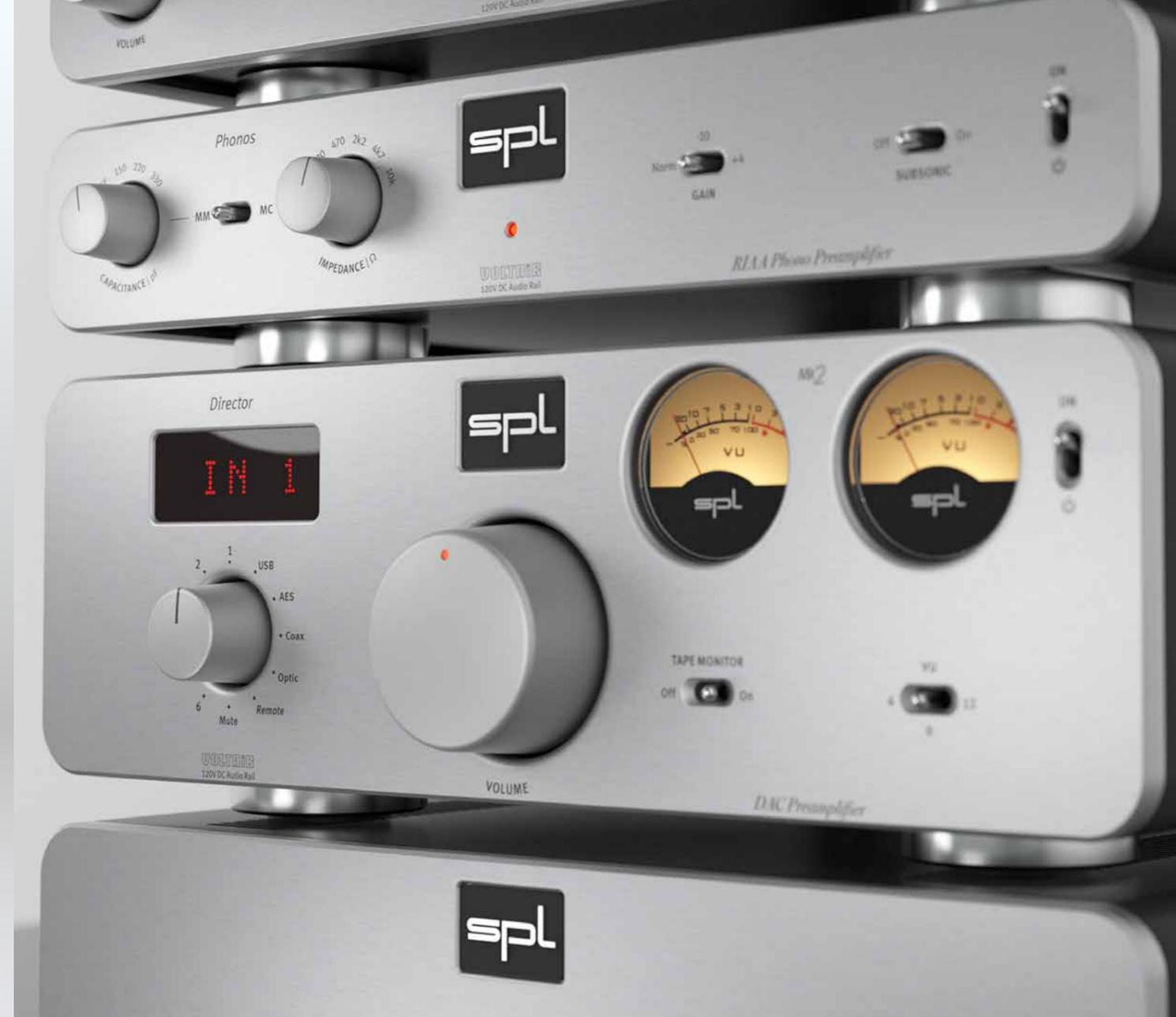
Der Phonos ist eine Phono-Vorstufe für Plattenspieler mit Moving Magnet (MM) oder Moving Coil (MC) Tonabnehmersystemen. Die RIAA-Entzerrungskurve ist nach dem legendären Douglas-Self-Design aufgebaut. Sie ist geeignet für alle Schallplatten seit 1954. Mit bis zu 71.5 dB Verstärkung für MC-Tonabnehmer und 50 dB Verstärkung für MM-Tonabnehmer gehört der Phonos zu den leistungsstärksten Phono-Vorverstärkern.
