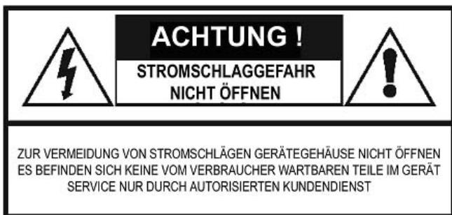
Dieses Blitzsymbol mit Pfeilspitze innerhalb eines gleichseitigen Dreiecks soll den Benutzer darauf aufmerksam machen, dass innerhalb des Gerätegehäuses nicht isolierte „gefährliche Spannungen“ vorhanden sind, welche von ausreichender Größe seinkönnen, um ein Risiko eines Stromschlags darzustellen.
