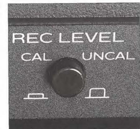
Per Knopfdruck: kalibrierter Pegel übers Mischpult (Cal) oder Aufnahmeaussteuerung am Gerät.
