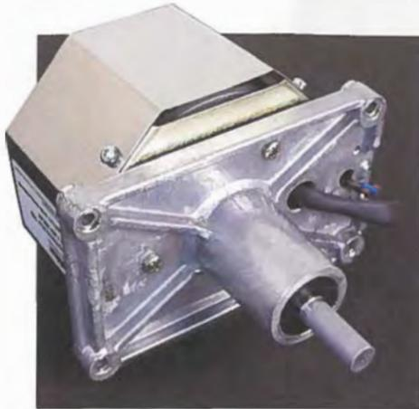
Der neue Motor für die aufwendige Capstanwelle übernimmt vom früheren Typ nur den Anker.
