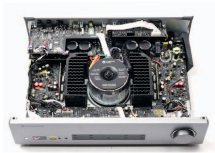
Wirklich audiophil: Die Signalwege sind kurz, in der Mitte bietet ein großer Ringkerntrafo die nötige Spannung auf.
