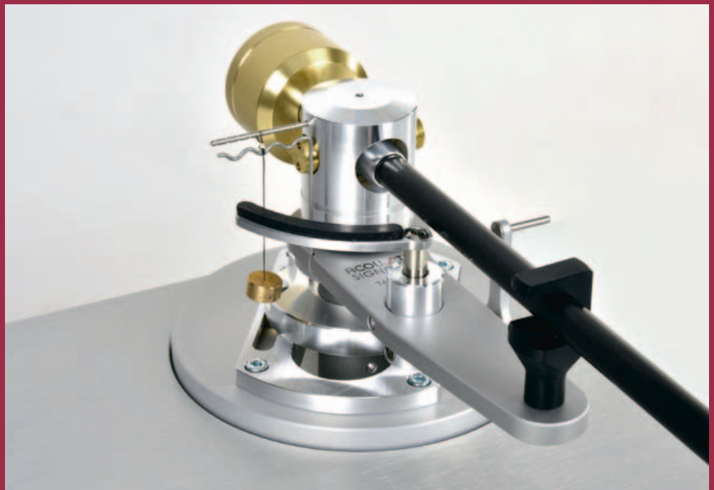
Der Arm kompensiert die Skating-Kraft über ein Gewicht an einem Faden. Der Armlift ist herrlich: Man tippt den Hebel leicht an, und der Arm senkt sich wunderbar geschmeidig ab.
