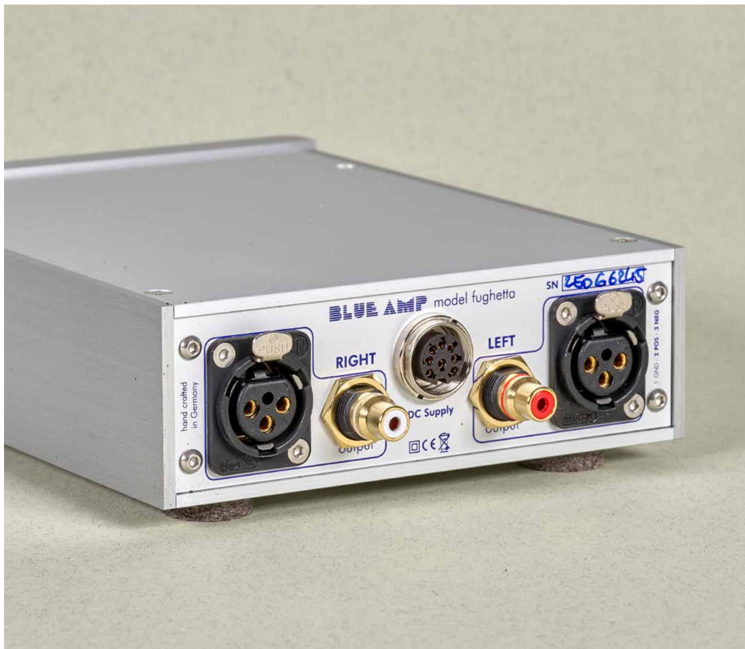
Modell: fughetta, Seriennummer: handnotiert – mittig unverkennbar der Achtpol-Anschluss des externen Netzteils. Symmetrie gehört bei Blue Amp fest zum Entzerrerkonzept, und zum Glück wird sie auch von immer mehr Plattenspielern geboten. Sollte Ihrer nicht dazugehören, ist das kein Problem. Adapter sind optional erhältlich.
